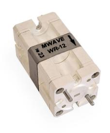
Предлагаемый изолятор Фарадея покрывает полный частотный диапазон 60 — 90 ГГц. В используемой конструкции изолятора используется продольный намагниченный ферритовый стержень, который вызывает вращение плоскости поляризации электромагитной волны, проходящей через устройство.
